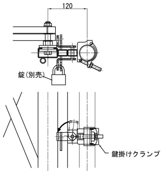
注) 強風が予想される時にはゲートを全開し、柱に結束固定などの養生措置を講じて下さい。
