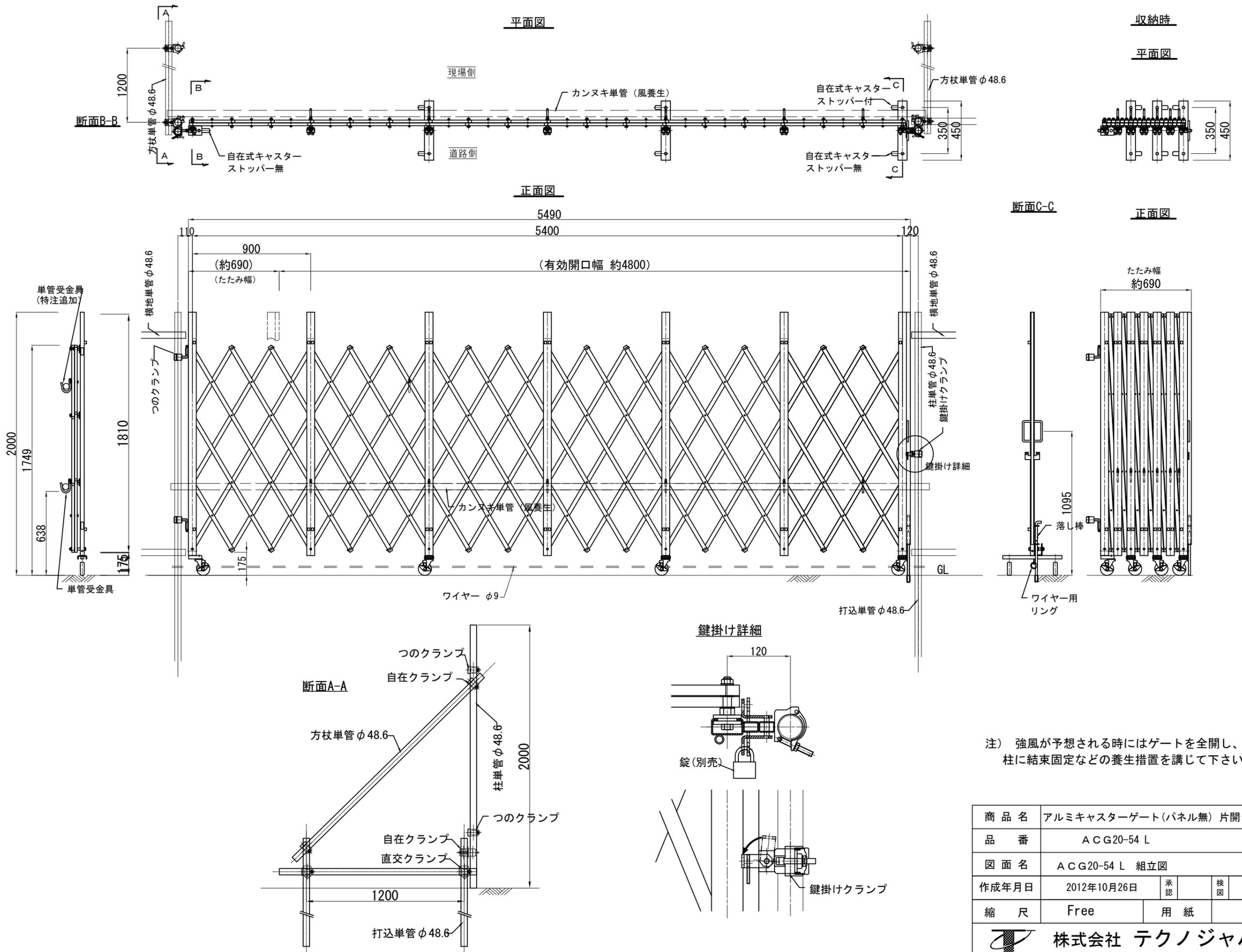
注) 強風が予想される時にはゲートを全開し、柱に結束固定などの養生措置を講じて下さい。
