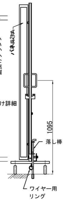
注) 強風が予想される時にはゲートを全開し、柱に結束固定などの養生措置を講じて下さい。
