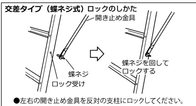
●左右の開き止め金具を反対の支柱にロックしてください。
