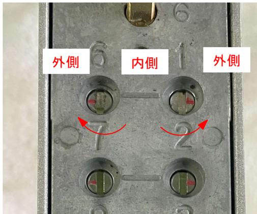
⑥新規に記録する番号のロックピンの横溝を中央部の横溝に合わせして下さい。
