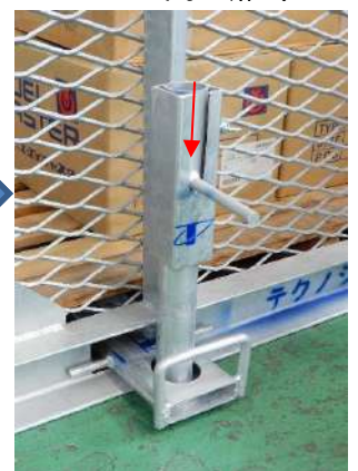
抜け止めの落とし棒を下まで落とす
