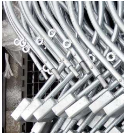
製作商品:特注鋼製テントフレーム
