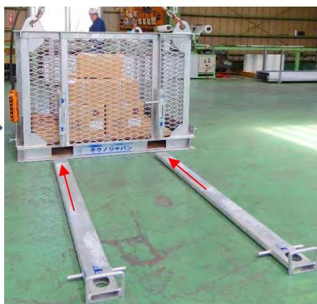
抜け止めの落とし棒を下まで落とす
